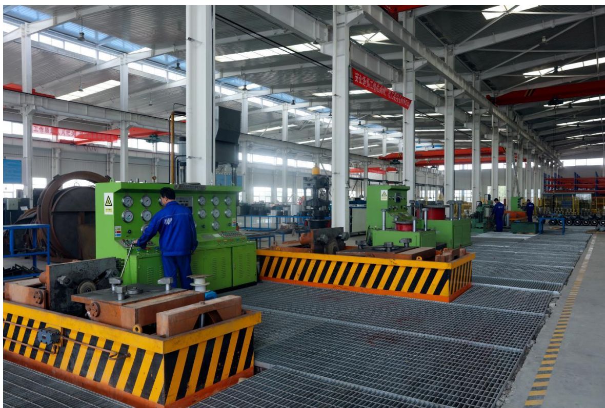
大口径气液压密封试压设备
