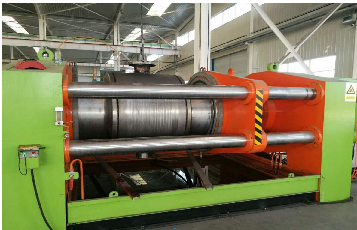
大口径气液压密封试压设备
